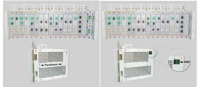
Figura 5 - CH16 Total equipado con 3 tarjetas filtro en el 17° slot y una CMFT en el 16° slot. También muestra los tornillos que fijan la mecánica que sirve de guía para las tarjetas filtro y la tapa del conector Combicom.
